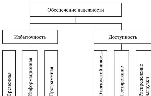
Рис. 3. Классификация методов обеспечения надежности
