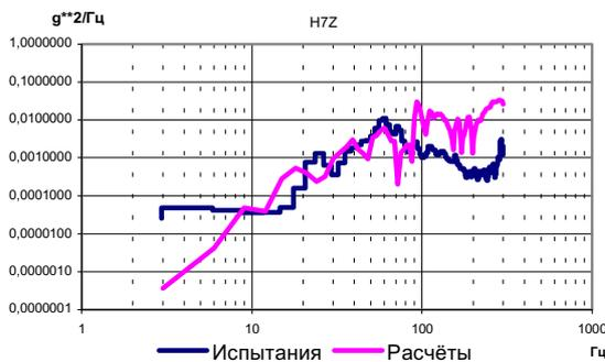
Рис. 6. Отклики ускорений при акустическом возбуждении (ось Oy КА)
