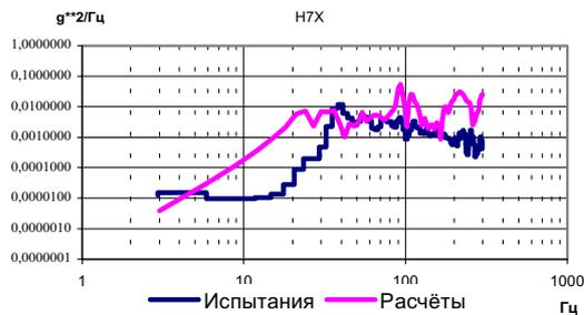
Рис. 5. Отклики ускорений при акустическом возбуждении (ось Ox КА)
