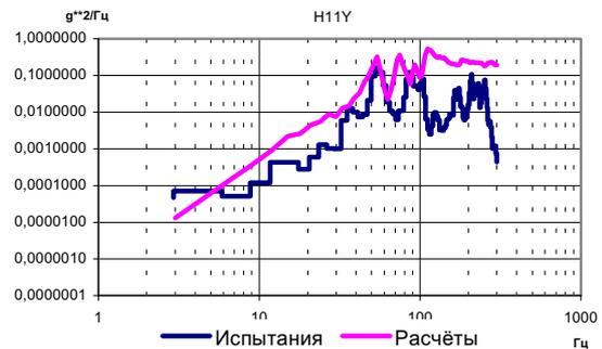
Рис. 7. Отклики ускорений при акустическом возбуждении (ось Oz КА)
