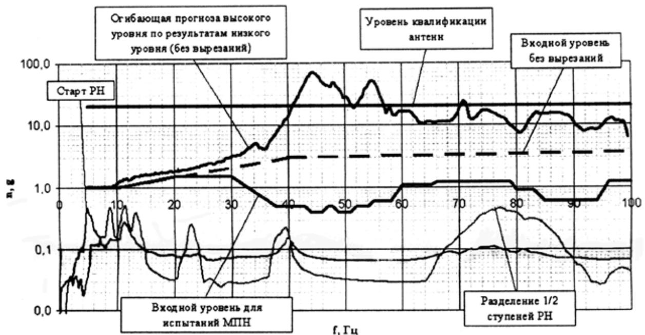
Рис. 2. Входной уровень возбуждений для проведения виброиспытаний МПН КА «Экспресс-АМ1» на воздействие гармонических вибраций по одной из осей
